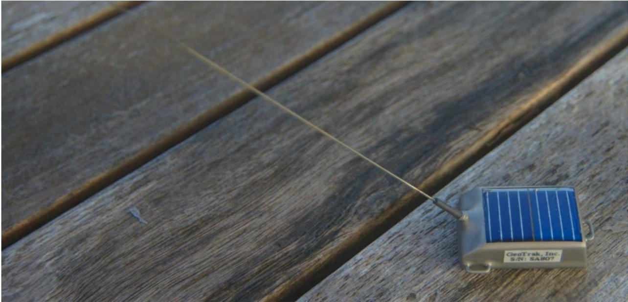
Figura 23. Emisor PTT solar de North star utilizado para el marcaje de pardela chica en Canarias.
