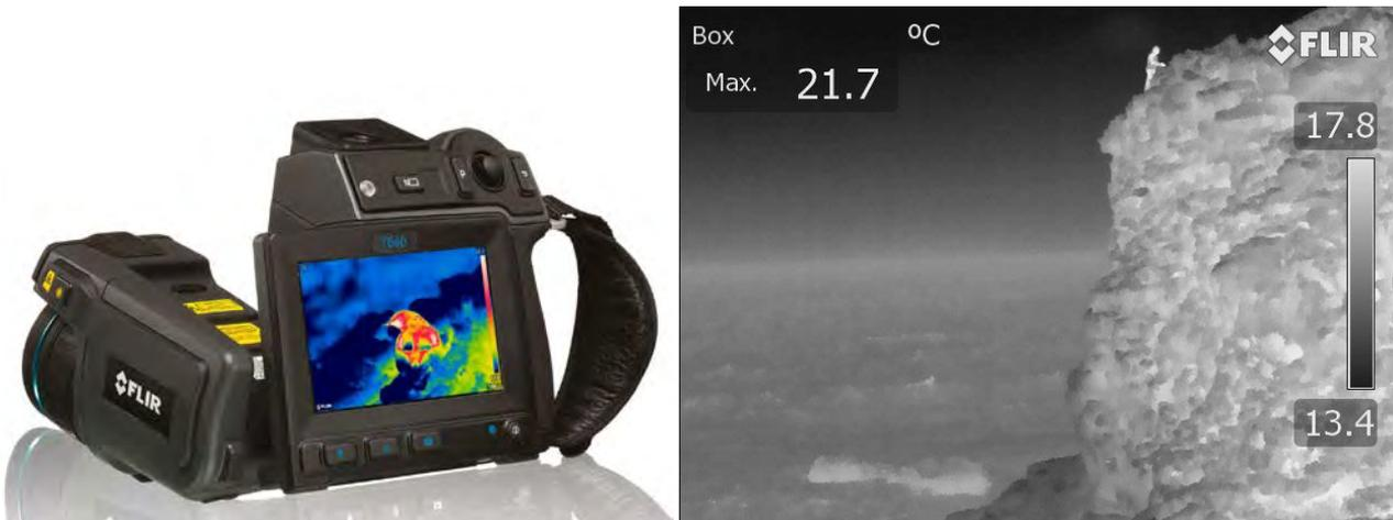
Figura 14. Cámara termográfica Flir T640 utilizada a modo experimental para la localización de nidos. Un miembro del equipo prospeccionando el acantilado durante la noche. Fotos: Juan Bécares y Marcel Gil
